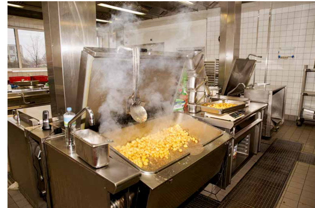
Um eine solche Menge an Essen kochen zu können, reicht keine kleine Pfanne aus – hier kommen sogenannte Kipper zum Einsatz.
